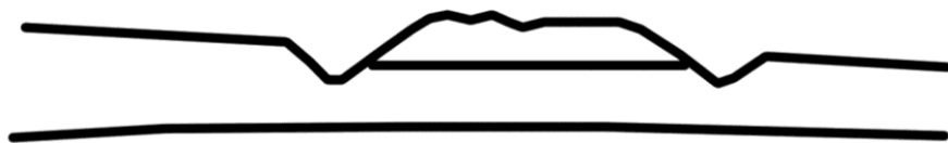
Рис. 53. Разрез земляного полотна дороги в пойме у д. Бергамак Муромцевского района Омской области [Татауров, Тихонов, 1996, с. 109]
